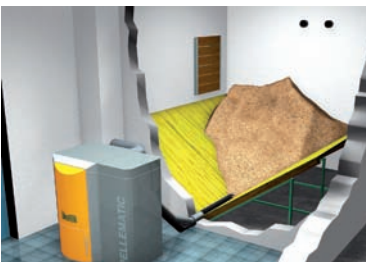
TRANSFERT PAR VIS AVEC SILO MACONNÉ OU SILO EN TOILE © ÖKOFEN
