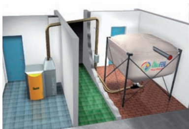
TRANSFERT PAR ASPIRATION AVEC SILO MACONNÉ OU SILO EN TOILE © ÖKOFEN
