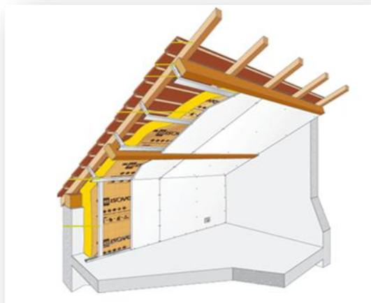
**L'isolation sur toiture**, réalisée au moyen de panneaux de toiture porteurs qui comprennent le support ventilé de couverture, l'isolation et le cas échéant le parement de sous-face. Cette technique augmente le volume habitable, assure une isolation continue et durable, préserve la charpente des variations de température et d'humidité et garantit la ventilation de la couverture.
