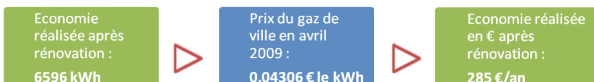
La mise en œuvre d'une isolation de 30 cm en toiture permet une économie de 6596 kWh soit au prix du kWh gaz au 1<sup>er</sup> avril 2009 une **économie financière de 285 €/an**.
