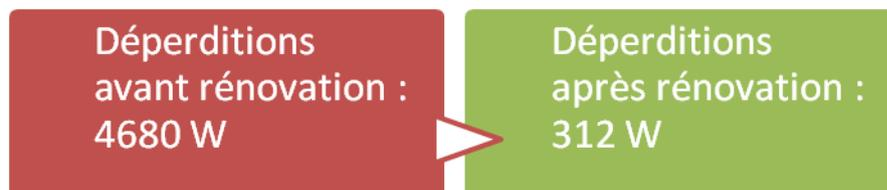
Après la mise en œuvre d'un isolant de 30 cm entre les chevrons permet d'évitez la déperdition de chaleur de 4368 W.
